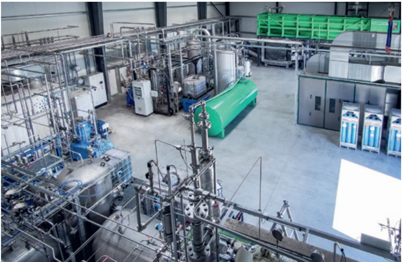
Blick in die TCR®-Technikumshalle für das TO-SYN-FUEL-Projekt im Markt Hohenburg, Landkreis Amberg-Weilburg: Gesamtanlage mit TCR®-Einheit, Gasstrecke, Wasserstoffabtrennung und Hydriereinheit. Quelle: Fraunhofer UMSICHT
