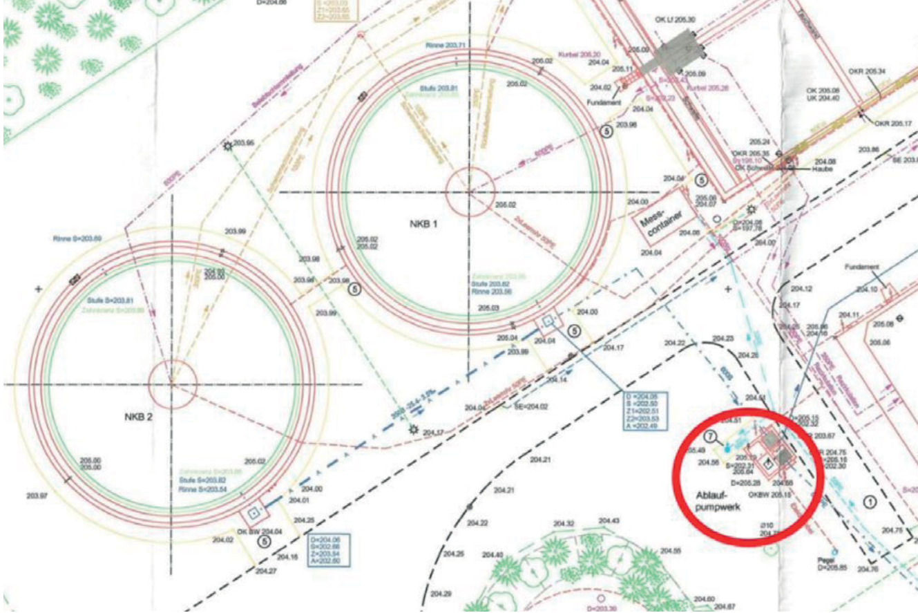
Ø1 Einbindung der Abwärmeauskopplung am Ablauf der Kläranlage Schmölln
